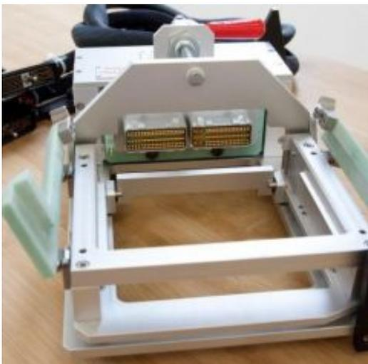
elektr. Kontaktierung an Stecker Leiterplatte oder Produkt-Gehäuse
